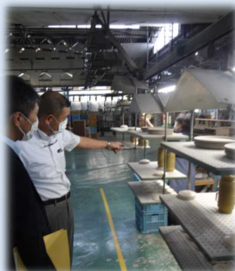
・全長370mのリフトコンベアを用 いて乾燥・搬送する工程
