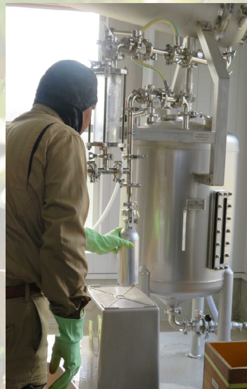
文旦の剥いた皮を蒸留し、オイルを抽出しています。
