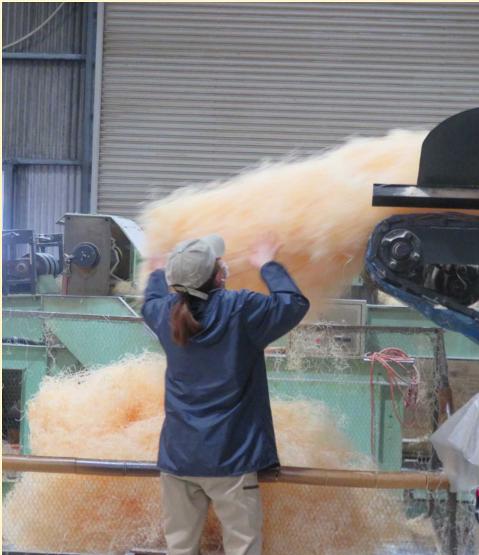
もくめんは製造機で原木を削り、乾燥させて作られます。
