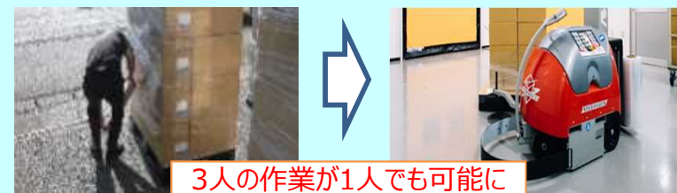
作業時間は1/3に 重労働の型抜き作業を機械化
