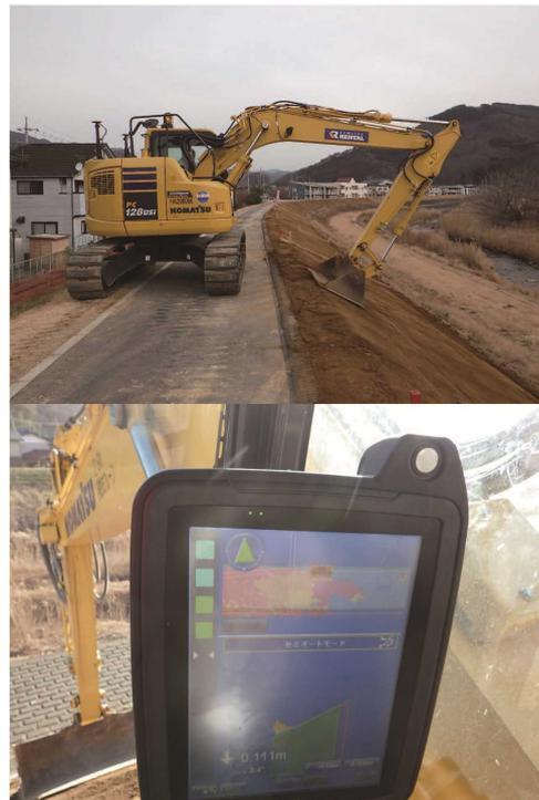
【GPSを用いて自動制御で作業を行う、建設機械】
