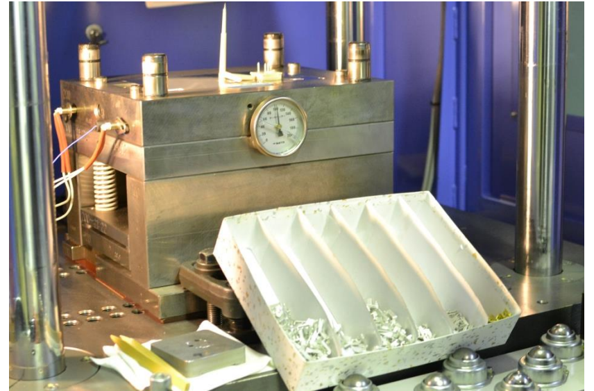
縦型成形機での端子インサート試作成形（成形品：リレー）
