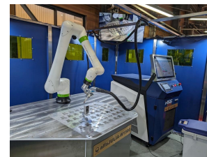
溶接ロボット
