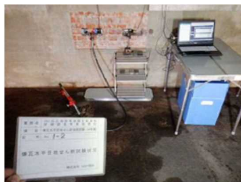
煉瓦目地せん断試験実施状況
