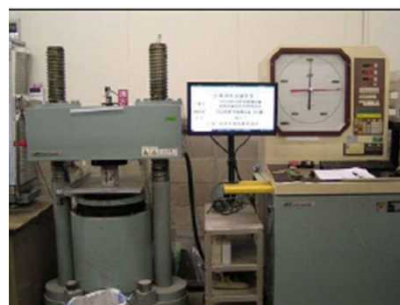
圧縮強度試験状況
