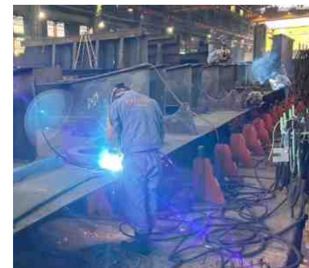
船体ブロックの溶接作業の様子
